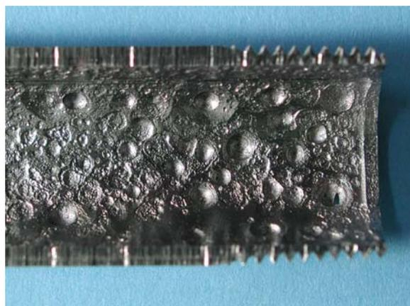
写真－5 ボイラー給水管内面
